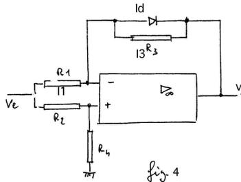
C'est bien évidemment la diode du bas qui est passante puisque  $V_e$  est «fortement» positif. Le théorème de MILLMANN ne s'applique plus à la borne inverseuse à cause de la non-linéarité de la diode. Par contre, on peut dire  $V_- - V_s = V_d$  d'où  $V_- = V_s + V_d$ . Par contre on a toujours :
