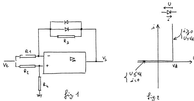
On réalise le montage de la figure 1 à gauche, où l'amplificateur opérationnel, parfait, fonctionne en régime linéaire et où les diodes sont idéales avec une tension de seuil  $V_d = 0,6 \text{ V}$  (on en rappelle la caractéristique sur la figure 2 à droite). Les résistances valent  $R_1 = R_2 = 30 \text{ k}\Omega$ ,  $R_3 = 20 \text{ k}\Omega$  et  $R_4 = 10 \text{ k}\Omega$ .
